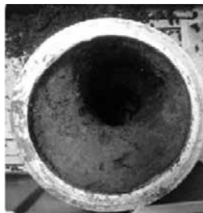
Рис. 1. Образцы срезов нефтепроводов с АСПО.
