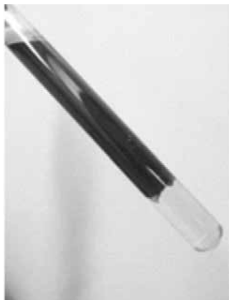
Рис. 1. Нефть Б с раствором хлорида натрия после статического взаимодействия.
