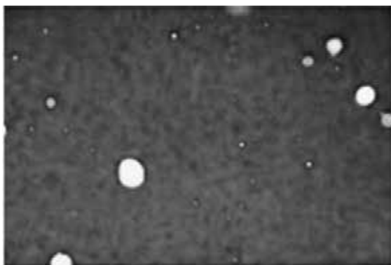
Рис. 2. Оптическая микрофотография нефти Б после взаимодействия с раствором хлорида натрия.
