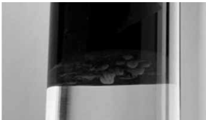
Рис. 3. Фотография адсорбционного слоя на границе раздела фаз при минерализации солевого раствора 450г/л.
