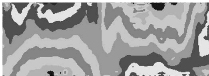
Рис. 5. График оседаний дна резервуара совмещенный с поверхностью деформаций.
