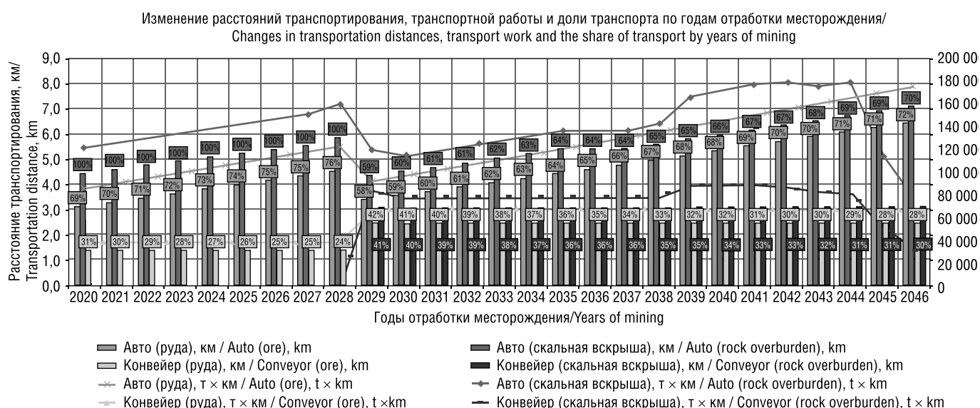
Рис. 2. Изменение параметров грузопотоков для рассматриваемых вариантов / Fig. 2. Changing the parameters of rock mass flows for the considerate options.
