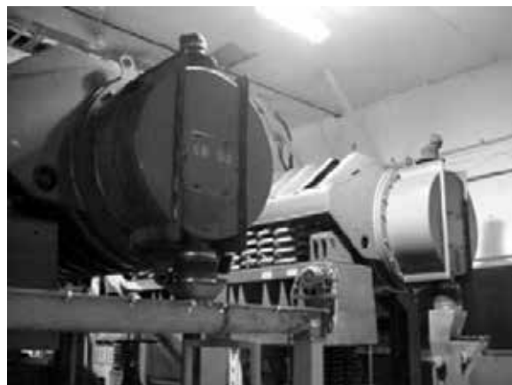
Рис. 8. Промышленная вибрационная мельница конструкции фирмы «General Kinematics» (США). / Fig. 8. Industrial vibrating mill designed by «General Kinematics» (USA).
