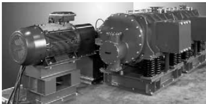
Рис. 7. Промышленная вибрационная мельница конструкции фирмы Siebtechnik 854-2ks (Германия). / Fig. 7. Industrial vibrating mill designed by Siebtechnik 854-2ks (Germany).
