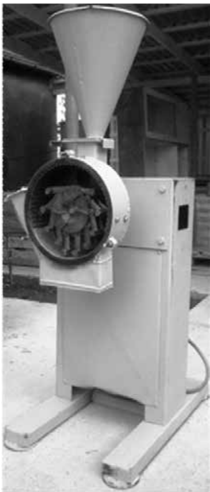
Рис. 1. Некоторые типы оборудования для тонкого и сверхтонкого измельчения горных пород: а) валковая мельница; б) молотковая мельница; в) струйная мельница; г) - дезинтегратор / Fig. 1. Some types of equipment for fine and ultrafine grinding of rock: a) - roller mill; b) - hammer mill; c) - jet mill; d) - disintegrator.
