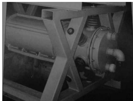
Рис. 11. Виброкинетическая мельница конструкции фирмы «Microgrinding corporation», США. / Fig. 11. Vibrokinetic mill designed by Microgrinding Corporation, USA.
