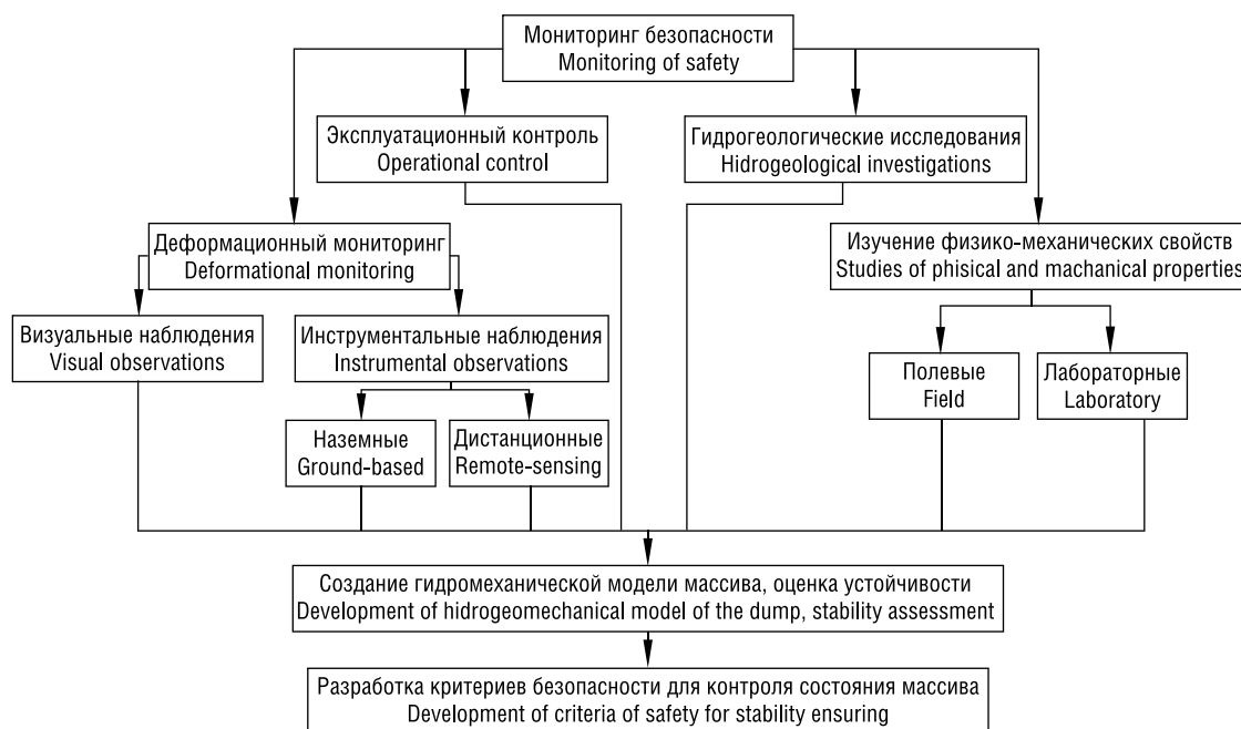
Рис. 1. Схема производства работ в рамках мониторинга состояния объектов складирования отходов углеобогащения / Fig. 1. Scheme of organization of monitoring on the coal waste dumps.
