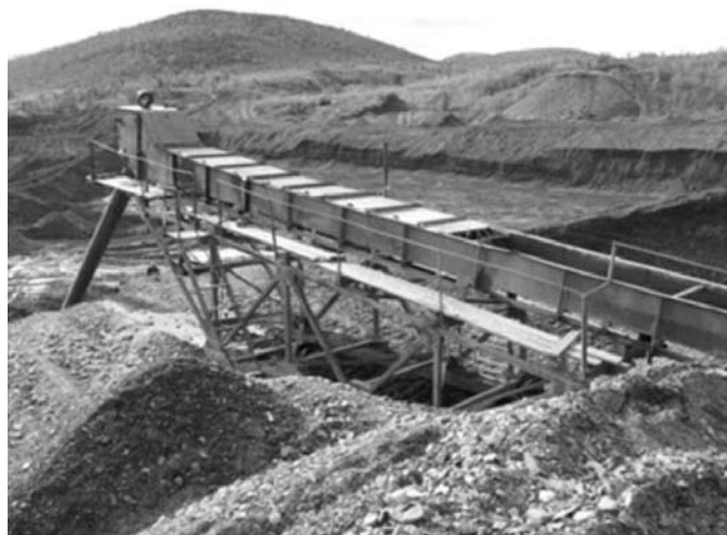
Рис. 1. Промывочный комплекс для извлечения золота / Fig. 1. Washing complex for gold extraction.
