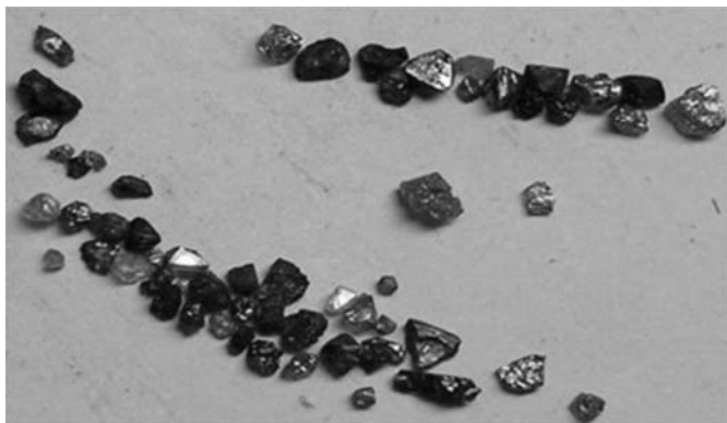
Рис. 7. Алмазные кристаллы, извлеченные из хвостов доводочных операций РЛС. / Fig. 7. Diamond crystals extracted from the tailings of finishing operations of X-ray luminescent separation.
