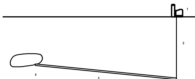
Рис. 2. Схема вибро-самотечного транспорта твердеющих смесей: 1- закладочный комплекс; 2 - скважина; 3 - квершлаг; 4 - рудное тело / Fig. 2. Scheme of vibratory and gravity transport of solid mixtures: 1 - fill complex; 2 - borehole; 3 - crossdrift; 4 - ore body.
