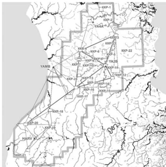
Рис. 2. Схема спутниковой наблюдательной сети Ямбургского ГДП / Fig. 2. Diagram of the satellite observation network of the Yamburg GDP.
