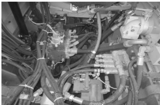
Рис. 3. Элементы гидропривода рабочего оборудования бульдозера Liebherr PR 724 / Fig. 3. Elements of hydraulic drive of bulldozer working equipment Liebherr PR 724
