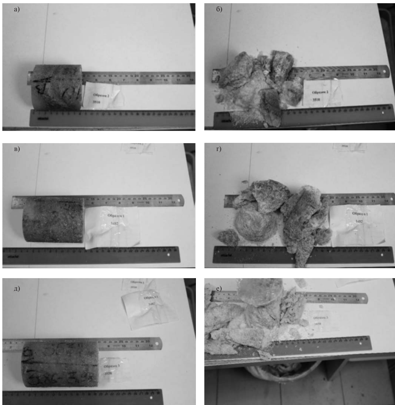
Рис. 4. Внешний вид образцов сильвинитовых пород, выдержанных в рассоле 36 суток до (а, в, д) и после (б, г, е) испытаний на одноосное сжатие /
