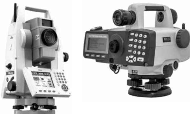
Рис. 3. Высокоточный тахеометр TS09plus. Электронный нивелир Sokkia sdl1x
