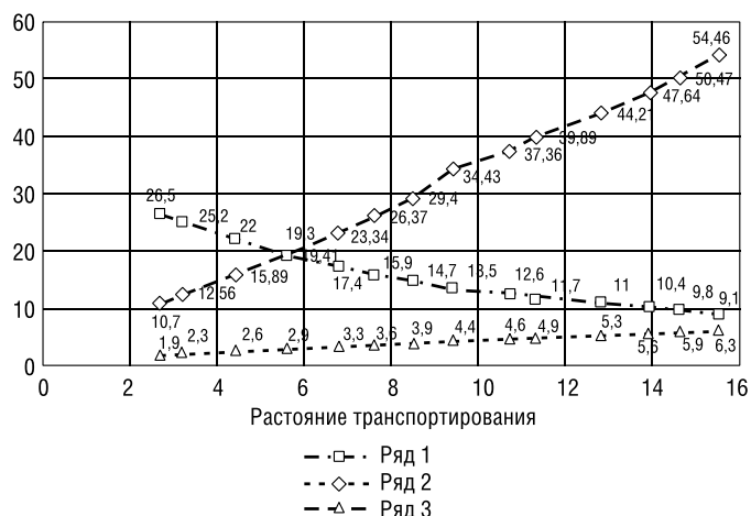
Рис. 1. Графики зависимости продолжительности рейса автосамосвала (ряд 1), количества рейсов в смену (ряд 2) и количества автосамосвалов, приходящихся на 1 фрезерный комбайн (ряд 3), от расстояния транспортирования горной массы для горнотехнических условий карьеров предприятия по производству цемента «Беочин»
