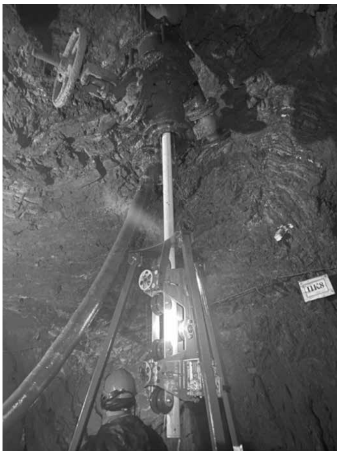
Рис. 3. Подача зонда в скважину
