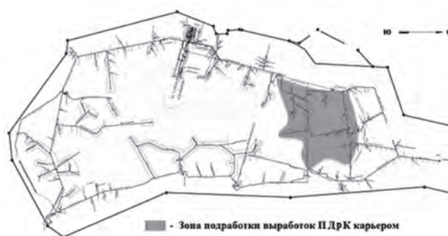
Рис. 3. Схема подземных горных выработок подземного дренажного комплекса с выделенной зоной подработки карьером Михайловского горно-обогатительного комбината (по состоянию на начало 2024 года) Fig. 3. The scheme of underground mining of the Pr with a dedicated part-time work area by the quarry (as of the beginning of 2024)
