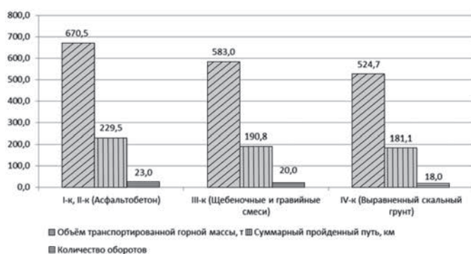
Рис. 2. График основных показателей работы автосамосвала за 24 часа при разных категориях дорожных одежд
