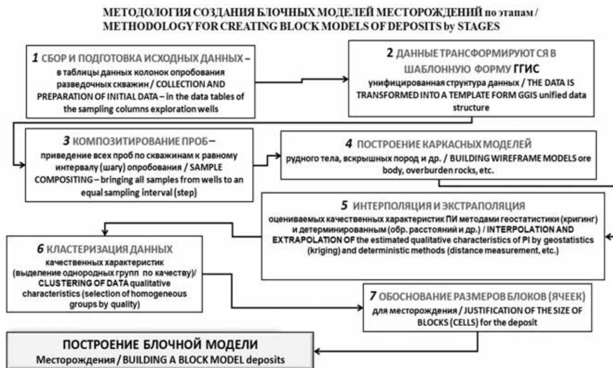
Рис. 3. Блок-схема методики построения блочной модели месторождения Fig. 3. Block diagram of the methodology for constructing a block model of the deposit
