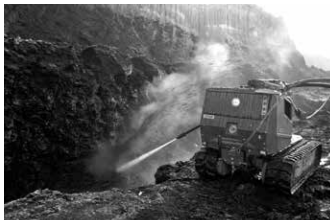
Рис. 14. Робот для испытаний гидрорезания компании HydroCoal Plus Fig. 14. HydroCoal Plus robot for waterjet cutting tests
