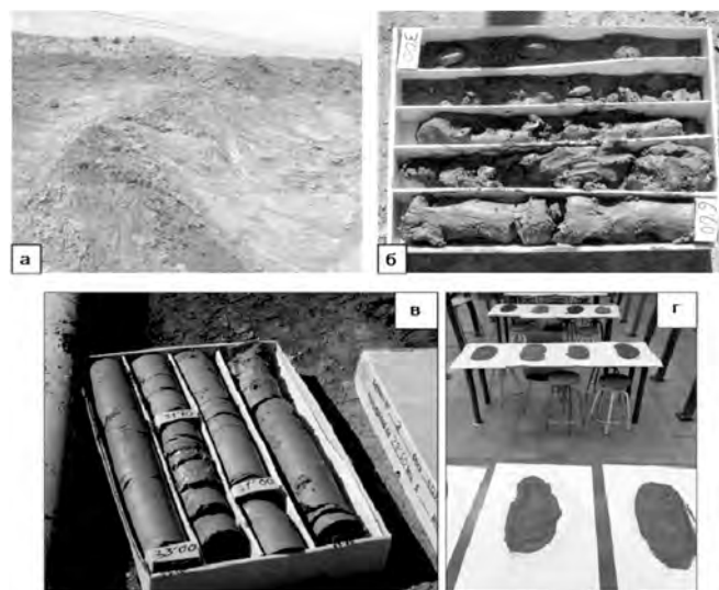
Рис. 5. Внешний вид лежалых отходов переработки Pb-Ag и Cu-Fe руд из хвостохранилищ Испании Brunita (а, б) [26] и La Aquisgrana (в, г) [27] / Fig. 5. Appearance of Pb-Ag and Cu-Fe ore processing waste from Brunita tailings ponds in Spain (a, b) [26] and La Aquisgrana (v, g) [27]
