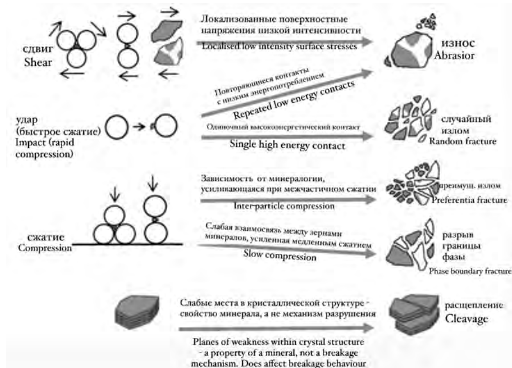
Рис. 1. Механизмы разрушения - определения и терминология, подчеркивающие предполагаемые связи между событиями при контакте (приложением силы) и результатом разрушения [18] /
