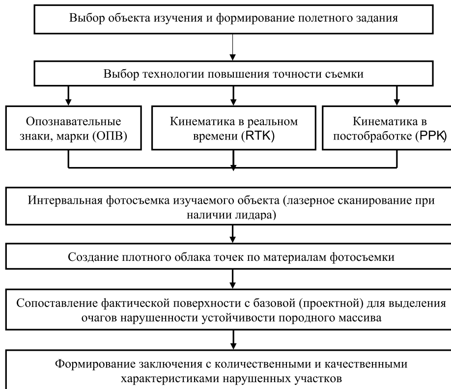
Рис. 1. Алгоритм мониторинга состояния массивов скальных пород / Fig. 1. Algorithm for monitoring the condition of rock formations
