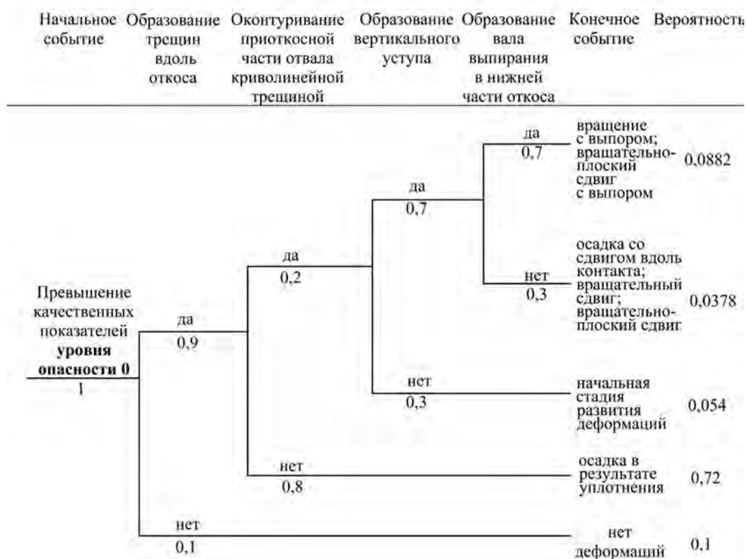
Рис. 3. «Дерево событий» развития деформации природно-технической системы «отвал — основание» / Fig. 3. «Event Tree Analysis» of the deformation development of the natural-and-technical system 'dump-foundation'
