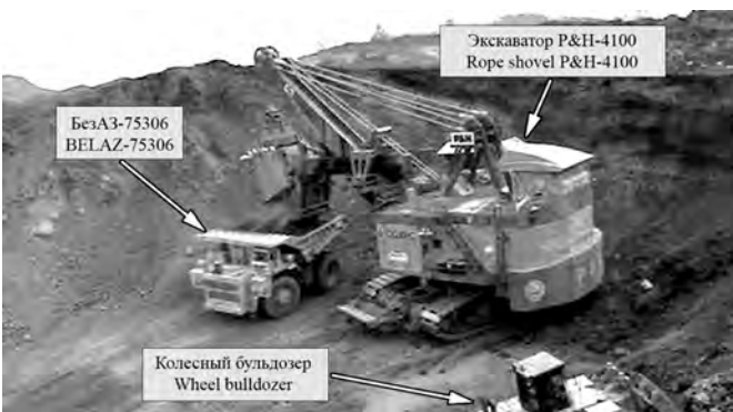
Рис. 7. Процесс погрузки экскаватором РН-4100 взорванной породы в «БелАЗ-75306» (220 т) и одновременная зачистка призабойного пространства колесным бульдозером /
