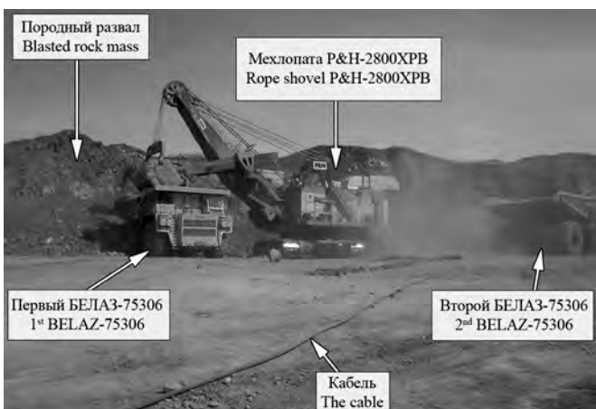
Рис. 3. Установка автосамосвалов «БелАЗ-75306» (220 т) под погрузку / Fig. 3. Positioning of dump trucks BelAZ-75306 (220 tons) for loading
