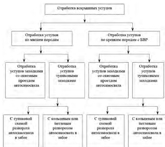
Рис. 10. Систематизация технологических схем ведения вскрышных работ в безугольной зоне /
