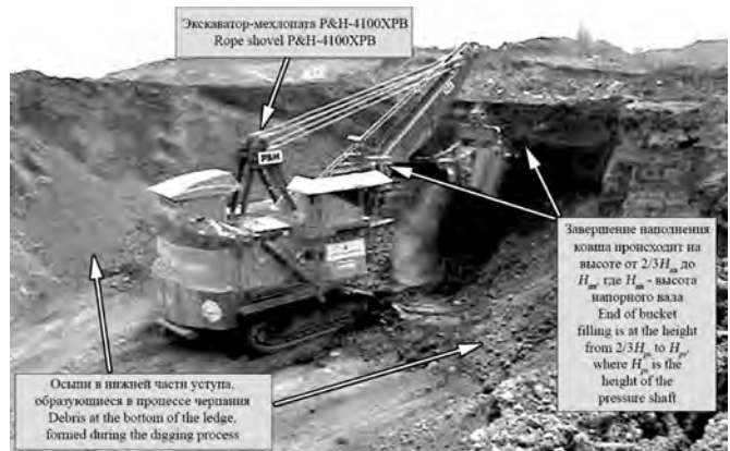
Рис. 6. Положение экскаватора РН-4100 на момент окончания наполнения ковша / Fig. 6. Position of P&H-4100 excavator at the moment of bucket filling completion
