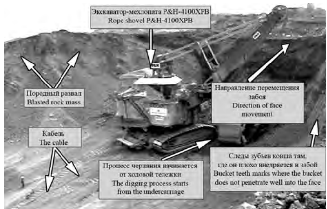
Рис. 4. Общий вид расположения Р&Н-4100 в забое / Fig. 4. General view of P&H-4100 location in the face
