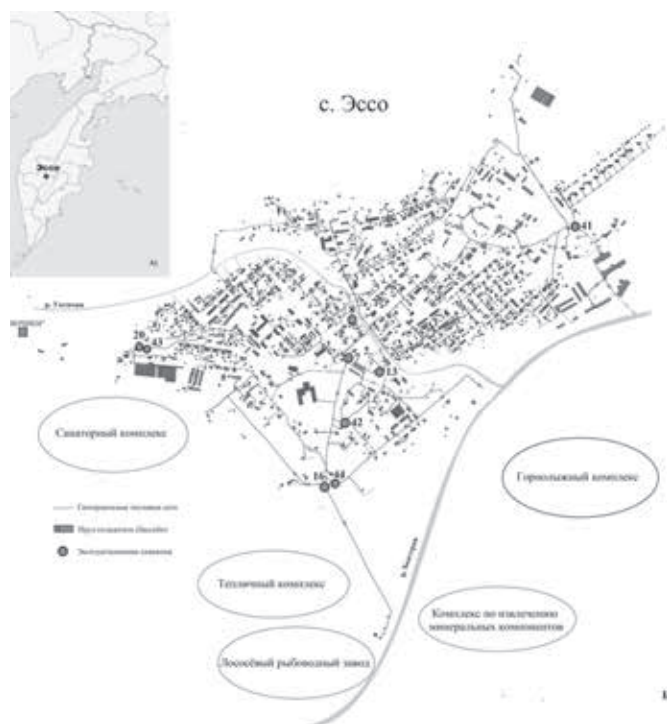
Рис. 1. Схема размещения объектов комплексного освоения Эссовского гидротермального месторождения: А – положение с. Эссо на карте Камчатского полуострова; Б – размещение эксплуатационных скважин (цифры соответствуют номерам эксплуатационных скважин) / Fig. 1. The layout of the facilities for the integrated development of the Essovsky hydrothermal field: А – the position of the village of Esso on the map of the Kamchatka Peninsula, В – the placement of production wells (the numbers correspond to the numbers of production wells)
