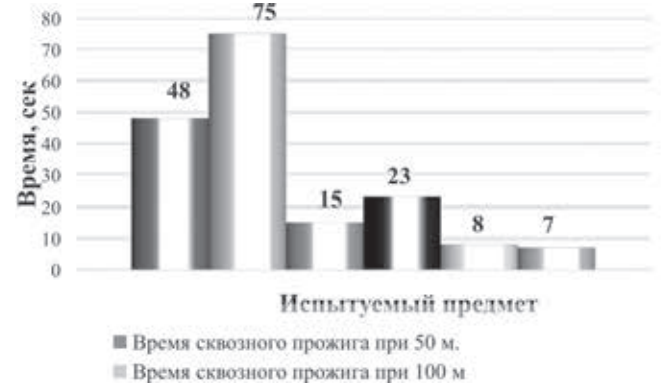
Рис. 10. Результаты воздействия лазерного луча на стальной лист толщиной 3 мм / Fig. 10. The results of the laser beam exposure to a 3 mm thick steel sheet
