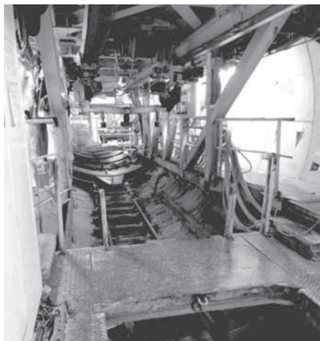
Рис. 1. Вид технологической тележки тоннелепроходческого механизированного комплекса с грунтопригрузом / Fig. 1. Type of TBM service trolley with soil load
