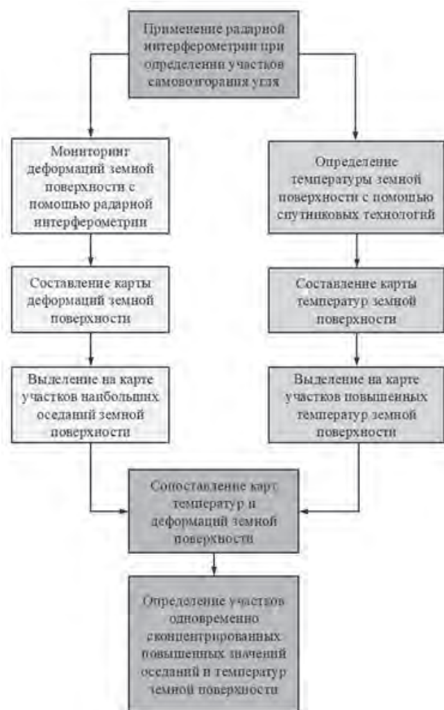
Рис. 2. Схема алгоритма проведения маркшейдерских работ при обнаружении очагов подземных пожаров с помощью радарной интерферометрии /
