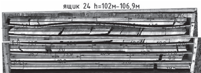
Рис. 3. Фрагменты определения размеров структурных блоков по глубине пробуренной скважины C-20-02 / Fig. 3. Excerpts from the sizing of structural blocks based on the depth of the drilled well C-20-02
