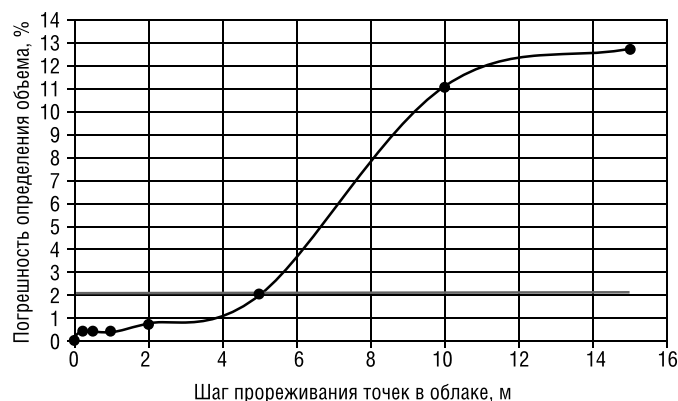
Рис. 8. Зависимость погрешности определения объема склада от плотности точек в облаке
