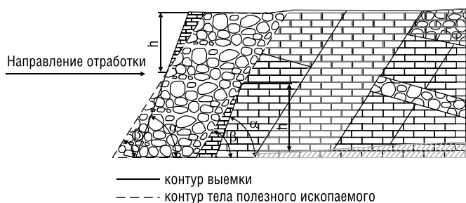
Рис. 2. Схема к расчету потерь известняка при разработке приконтактных зон с четкими плоскими контактами
