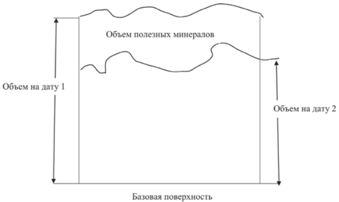
Рис. 2. Принцип расчета объема полезного ископаемого Fig. 2. The principle of calculating the volume of minerals
