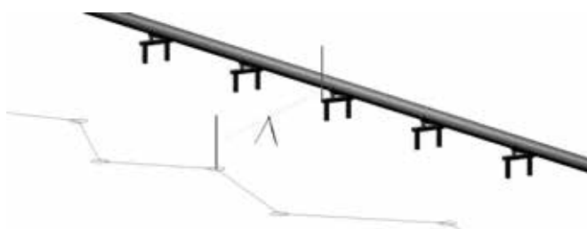
Рис. 1. Мониторинг трубопровода методом геометрического нивелирования Fig. 1. Pipeline monitoring using geometric leveling method
