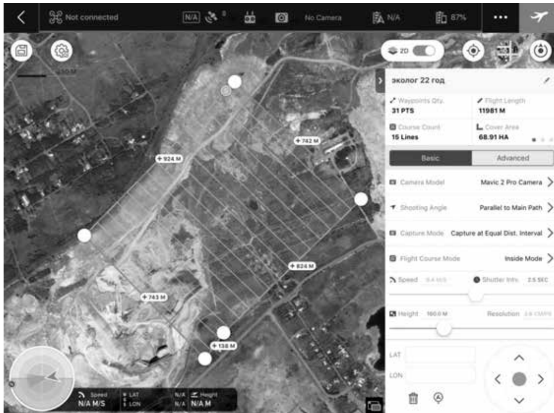
Fig. 3. Flight mission planning in DJI GS PRO for Ekolog Open-pit Mine / Рис. 3. Проект полетной миссии на разрезе «Эколог» в «DJI GS PRO»
