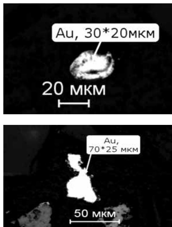
Fig. 2. Free gold particles in flotation concentrates. (Reflected light) / Рис. 2. Свободные золотины в флотоконcentратах. (Отраженный свет)
