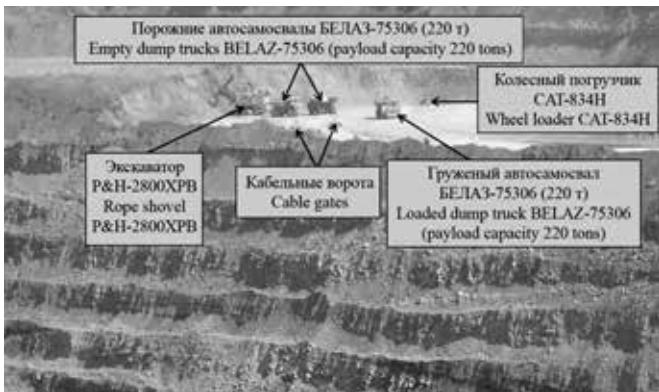
Рис. 1. Фрагмент общего вида горных работ основного поля разреза «Кедровский» (разработка безугольной зоны экскаватором Р&Н-2800ХРВ) / Fig. 1. Fragment of the general view of mining operations of the Main Field of the Kedrovsky open pit (development of the coalless zone by excavator P&H-2800XPB)
