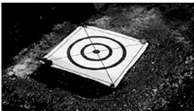
Рис. 3. Опознавательный знак для БПЛА / Fig. 3. Identification mark for an unmanned aerial vehicle
