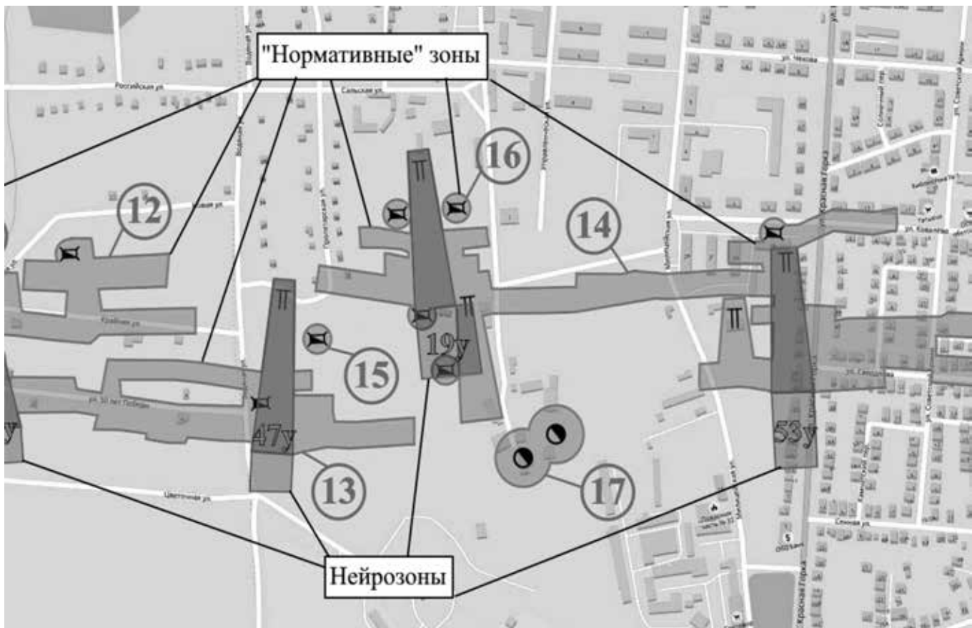
Рис. 2. Фрагмент плана поверхности шахты «Антрацит» с «нормативными» зонами, опасными по образованию провалов земной поверхности, и нейрозонами, представляющими угрозу провалообразования в ближайшие 20 лет
