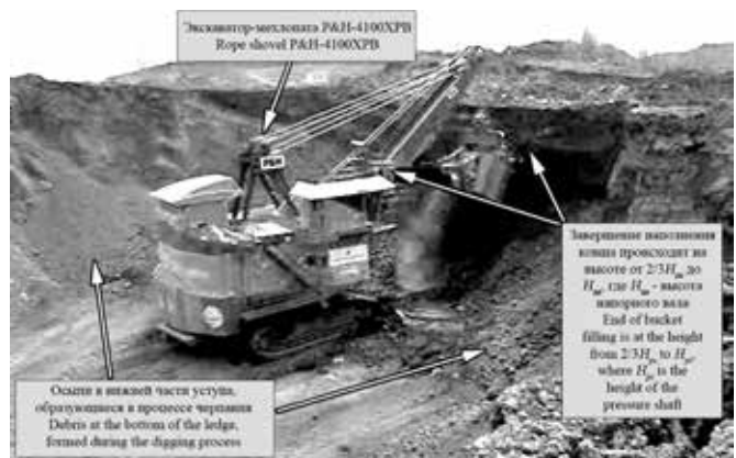
Рис. 6. Положение экскаватора РН-4100 на момент окончания наполнения ковша / Fig. 6. Position of P&H-4100 excavator at the moment of bucket filling completion
