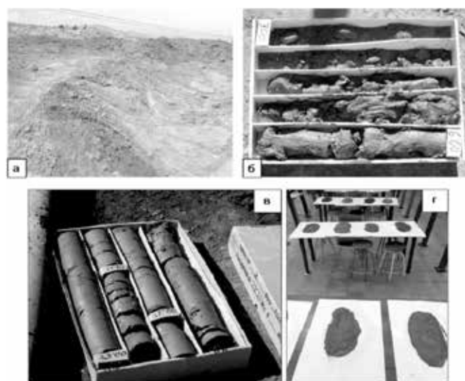
Рис. 5. Внешний вид лежалых отходов переработки Pb-Ag и Cu-Fe руд из хвостохранилищ Испании Brunita (а, б) [26] и La Aquisgrana (в, г) [27] / Fig. 5. Appearance of Pb-Ag and Cu-Fe ore processing waste from Brunita tailings ponds in Spain (a, b) [26] and La Aquisgrana (c, d) [27]
