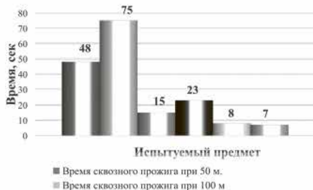
Рис. 10. Результаты воздействия лазерного луча на стальной лист толщиной 3 мм /
