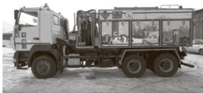
Рис. 1. Смесительно-зарядная машина «2К-11» на базе МАЗа, 6 х 4 / Fig. 1. Mixing and charging machine 2K-11 based on MAZ 6 x 4
