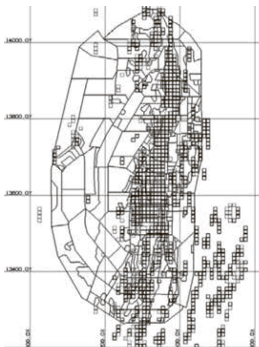
Рис. 7. Модель золоторудного месторождения «Агинское» (метод индикаторный кригинг) /
