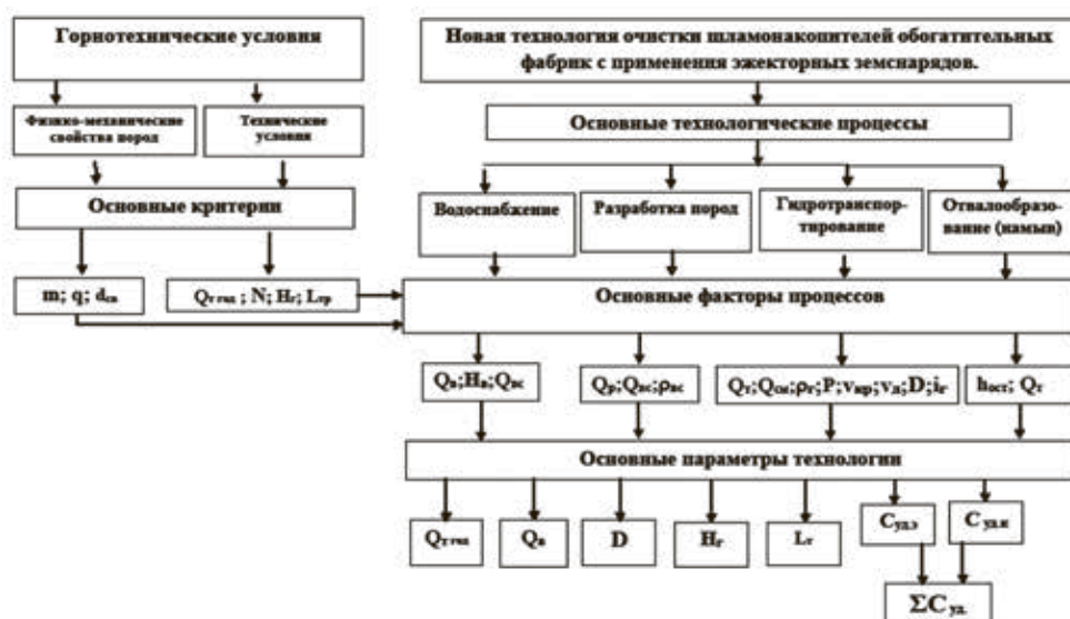
Рис. 1. Схема взаимосвязи критериев горнотехнических условий и основных факторов технологических процессов технологии очистки шламонакопителей с применением земснаряда /
