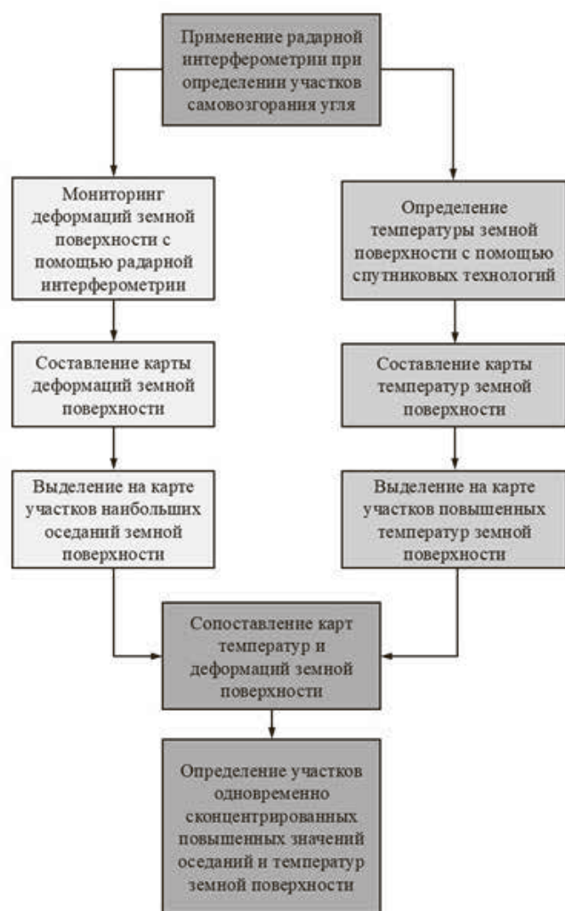
Рис. 2. Схема алгоритма проведения маркшейдерских работ при обнаружении очагов подземных пожаров с помощью радарной интерферометрии /
