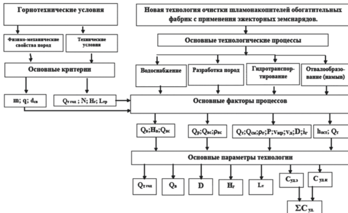
Рис. 1. Схема взаимосвязи критериев горнотехнических условий и основных факторов технологических процессов технологии очистки шламохранилищ с применением эжекторного земснаряда /
