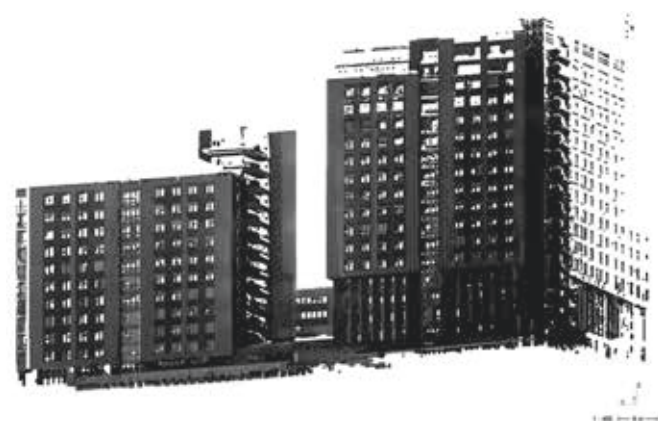
Рис. 4. Облако точек по результатам лазерного сканирования на станции 1. Вид 1 / Fig. 4. Laser scan point cloud acquired at Station 1 (View 1)
