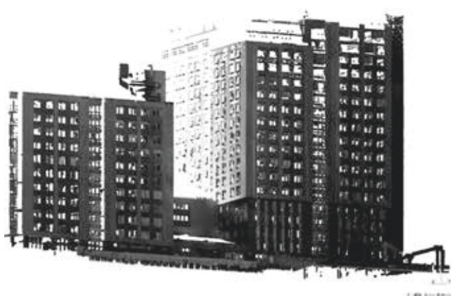
Рис. 5. Облако точек по результатам лазерного сканирования на станции 2. Вид 2 / Fig. 5. Laser scan point cloud acquired at Station 2 (View 2)
