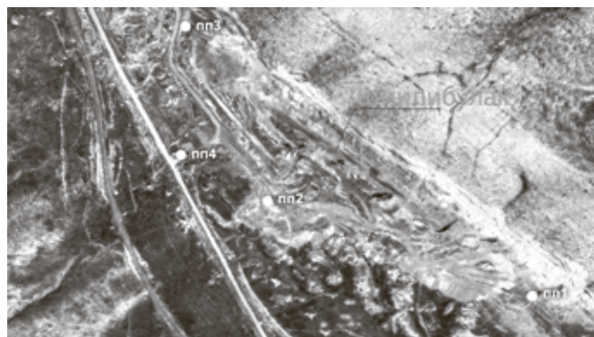
Рис. 1. Схема расположения наблюдательных пунктов геодезического мониторинга на космическом снимке карьера Шиилибулак / Fig. 1. Layout of geodetic monitoring observation points on a satellite image of the Shiilibulak quarry
